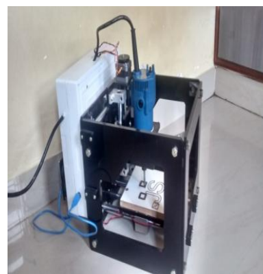
Fig 7.3 Final assembly of mini CNC machine
